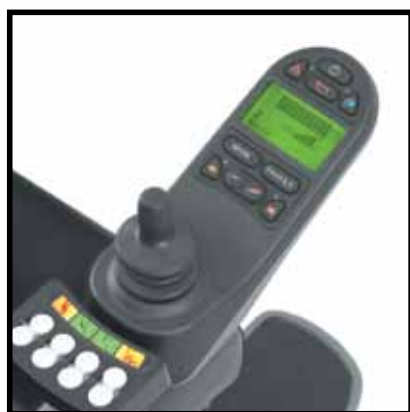
R-Net Elektronik mit ICS (Intelligent Control System)
