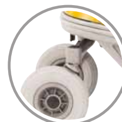
Drehbare Hinterräder zur raschen und wendigen Lenkung
